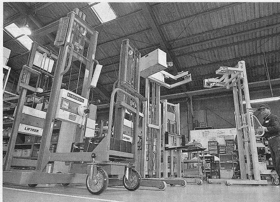
組み立てを終えたリフト。1台ずつ検査をしていく
